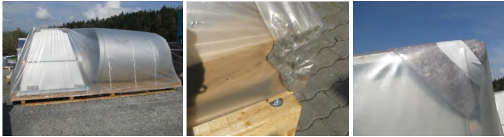
Bild: saubere, regen- und scharfen Kanten staubdichte Umhüllung mit PE-Folie Bild: „Antackern“ der Folie Bild: Unterfüttern von
