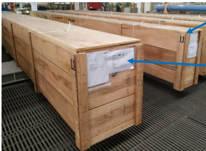
Abbildung 12: Verpackung in Holzkiste mit Handhabungsmarkierung und Signierung
