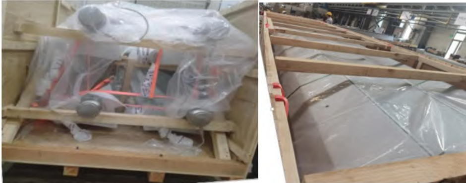
Abbildung 10, 11: Endmontage der Kiste gemäß VN 1577-1
