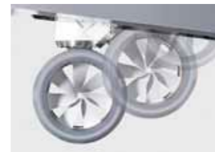
Der um 360 Grad drehbare VIP Swing-Out Azimuth Thruster fährt hydraulisch aus dem Schiff.
