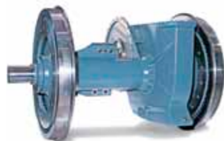
Komplettradsatz für die südkoreanische Staatsbahn.
