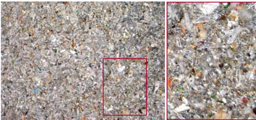
Links: Typische Rejekte aus der Schwertschmutzschleuse eines Protector Systems.
