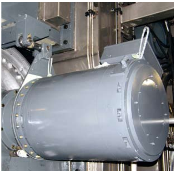
Rentabler: Synchronmotor im Einsatz (Voith Drive).
