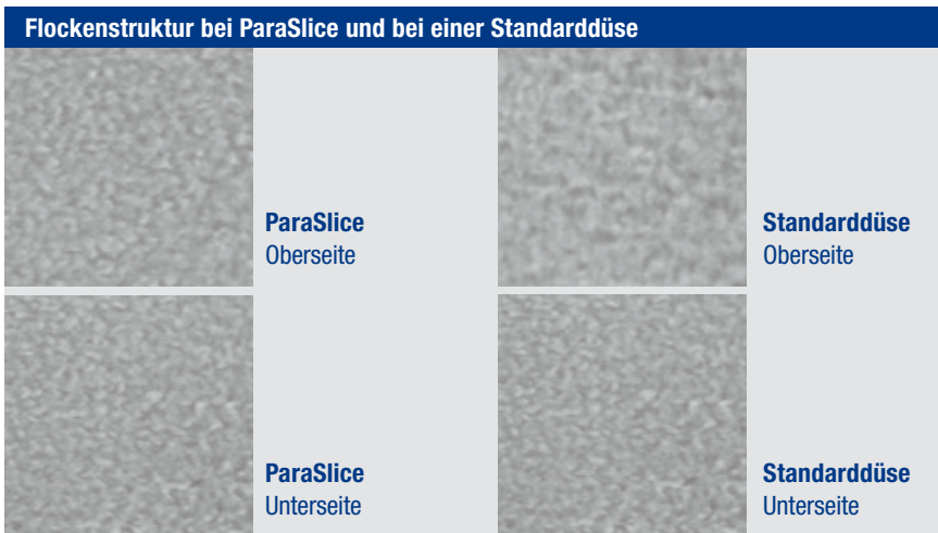
Abb. 5: Die unterschiedliche Flockung auf Ober- und Unterseite des Strahls wird mit ParaSlice minimiert.
