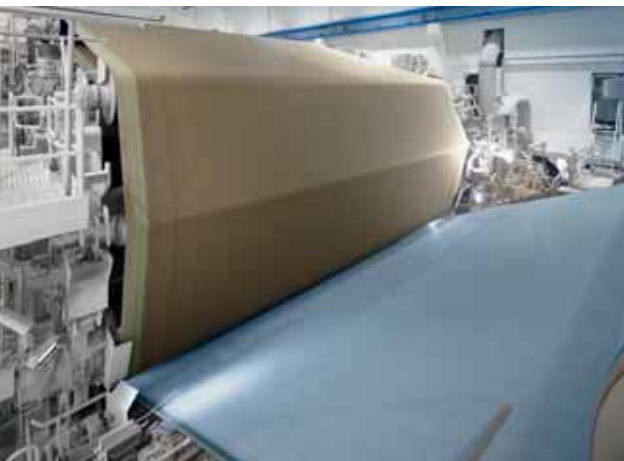
Abb. 1: Siebpartie und Pick-up-Filz.
