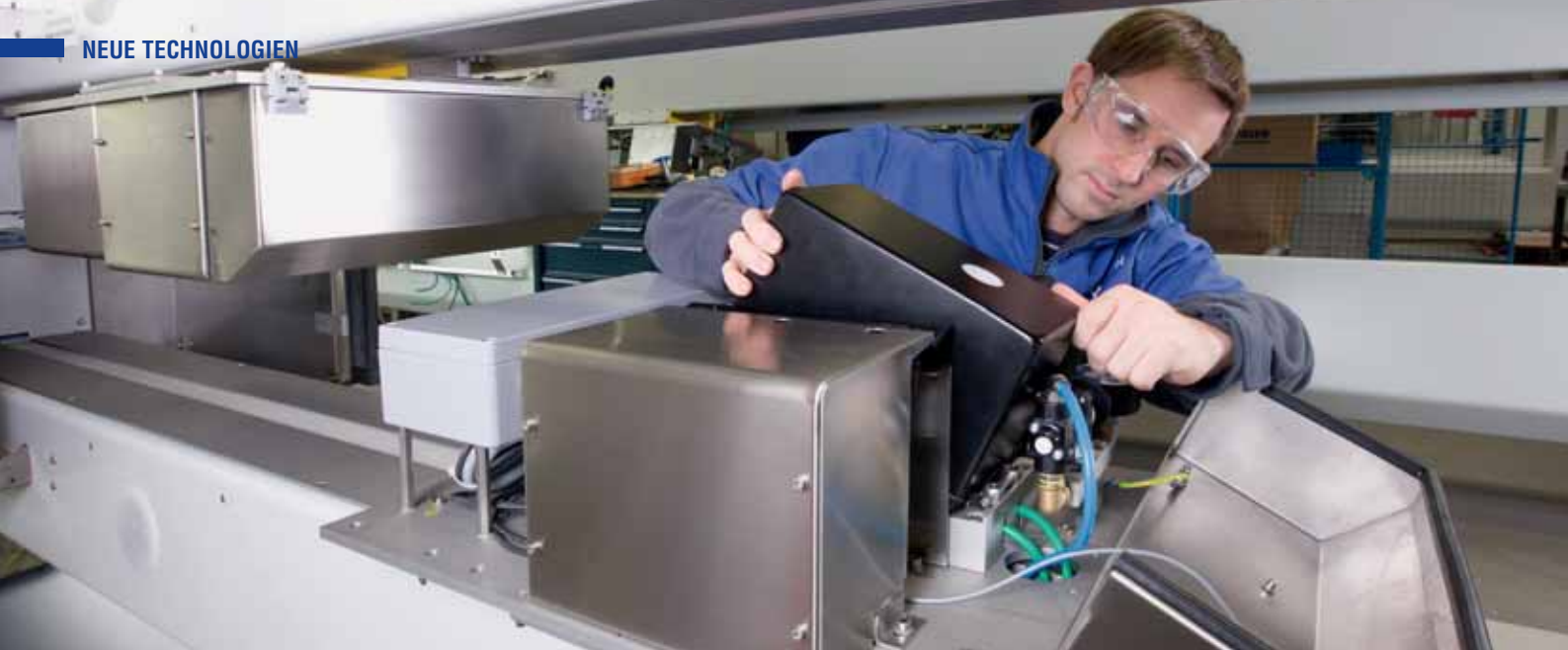
Abb. 1: Ein Voith Mitarbeiter montiert und testet das Voith LSC TecoScan System im Werk.
