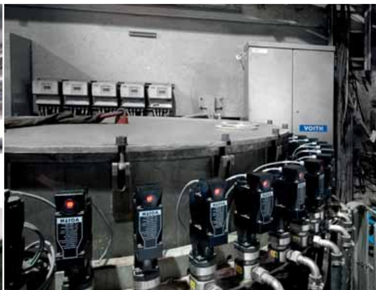
Abb. 2: OnQ ModuleTap Aktuatoren regeln den bestehenden Verdünnungswasserstoffauflauf.
