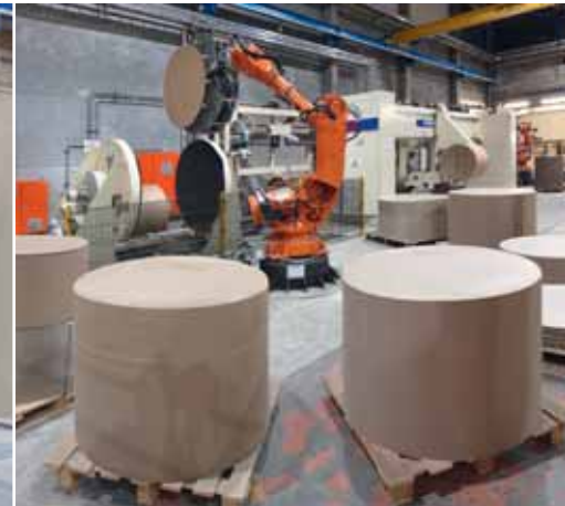
Abb. 3: Außendeckelroboter bei der Arbeit.
