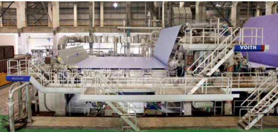
Abb. 2: DuoFormer D und DuoShake stellen die hohe Papierqualität schon im Bereich der Blattbildung sicher.
