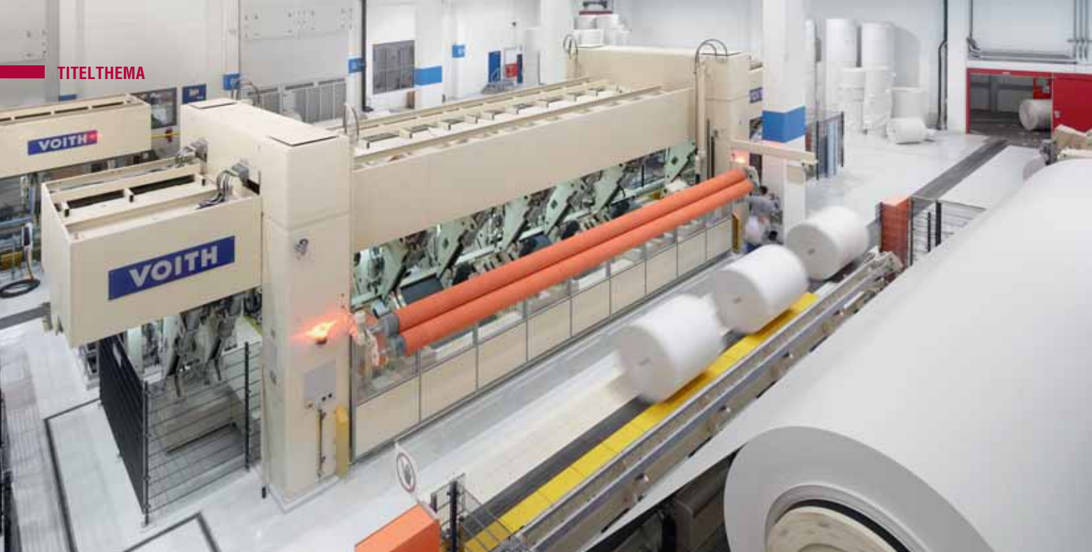
Abb. 4: Das Zentrumswickelprinzip der beiden VariTop Rollenschneidmaschinen sorgt für eine gute Kernwickelhärte; ein wichtiger Qualitätsparameter für die Verarbeitung in schnelllaufenden Druckmaschinen.
