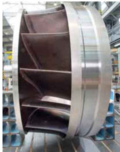
Abb. 1: Laufrad einer Francisturbine.
