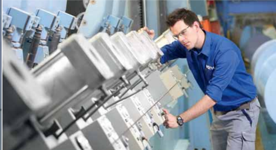
Abb. 3: Der Inbetriebnehmer mit einem prüfenden Blick auf die Andruckrollen.
