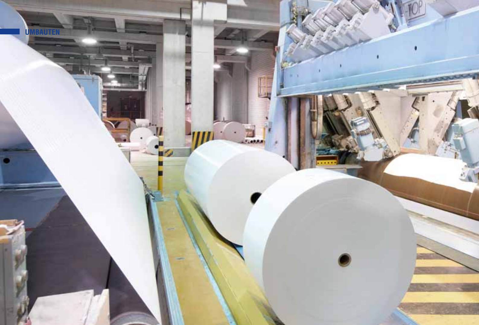
Abb. 1: Der Rollenschneider VariTop, ein Meilenstein in der Wickeltechnologie.
