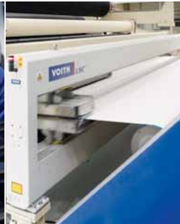
Abb. 3: Der Voith LSC Scanner prüft die Papierqualität.
