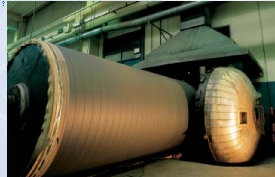
Abb. 3: Formierwalze mit Diamantite bezogen in der Härtekammer für Andritz AG, Walzengröße: 1500 x 1512 x 3300 mm).
