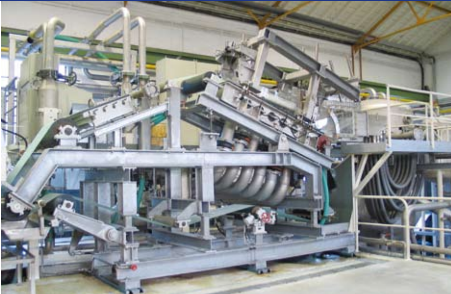
Kunden haben die Möglichkeit, auf der HydroFormer-Versuchsanlage in Düren Versuche zu fahren.
