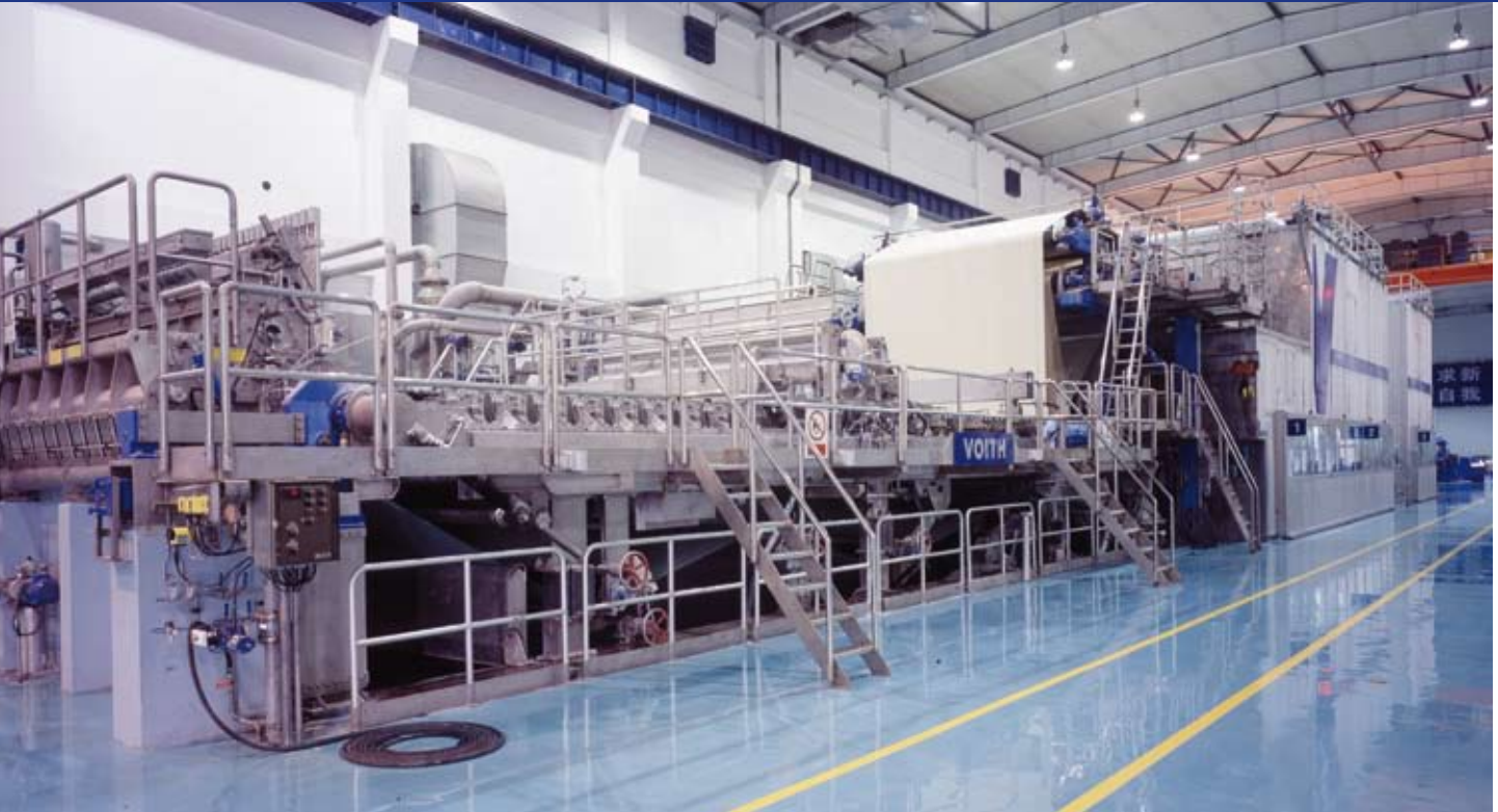
Diese Zigarettenpapiermaschine in China produziert 12.000 Tonnen Zigarettenpapier pro Jahr (links die Blattbildung, rechts die Trockenpartie).
