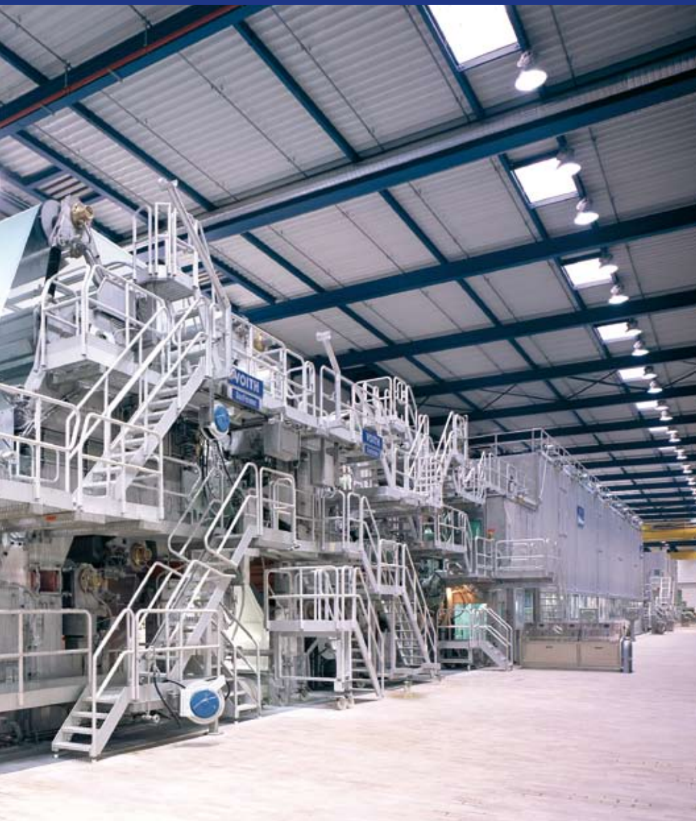
Die PM 2 bei Koehler in Kehl produziert ausschließlich Thermopapiere im Flächengewichtsbereich von 40 bis 80 g/m 2 mit einer Produktionsgeschwindigkeit von 1.600 m/min.
