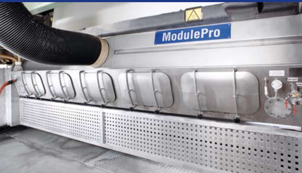
Der ModulePro C Düsenfeuchter befeuchtet die Papierbahn in der Streichmaschine.
